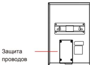
В. Совместите отверстие настенного кронштейна на задней стороне динамика с двумя винтами и закрепите его, чтобы зафиксировать без шатания.
