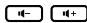
В режиме ожидания или во время звонка: Увеличить или уменьшить громкость звонка. Во время разговора: Увеличить или уменьшить громкость в трубке или гарнитуре
